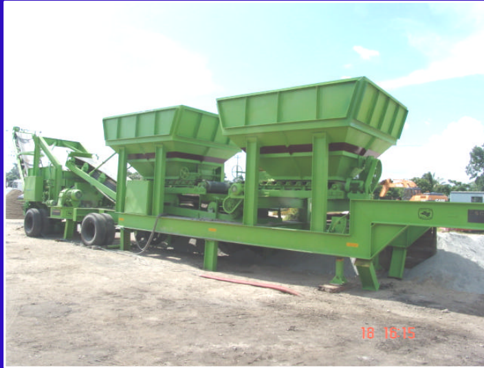
PLANTA ESTABILIZADORA MARCA ESCUDERO PARA PROCESAR SUELO-CEMENTO CON RENDIMIENTO DE 400 TON/HR, MODELO MAFE-400
