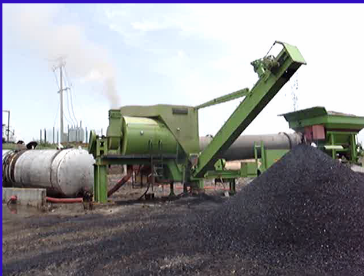
PLANTA MEZCLADORA ESCUDERO MODELO PEMC-30 (“La chiquita”)
